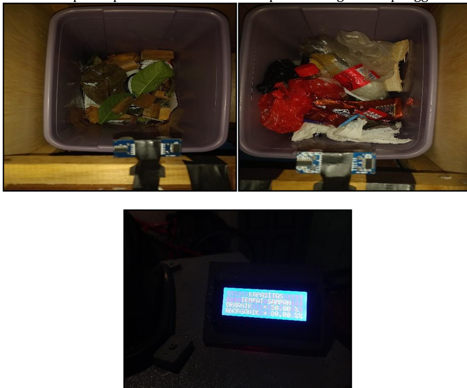
Gambar 5. Hasil Pengujian Sensor Ultrasonik Dan LCD
