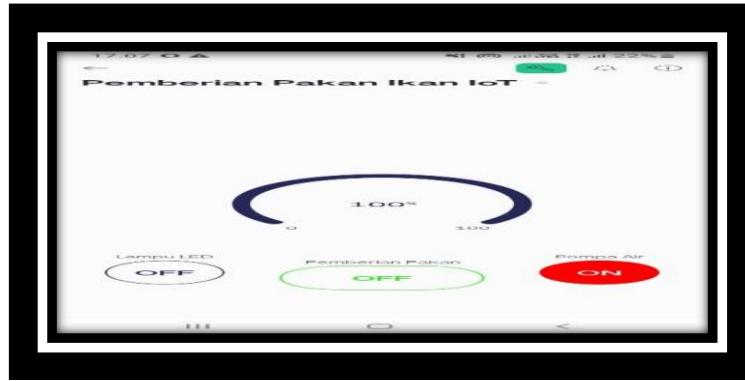
Gambar 5. Hasil interface aplikasi blynk untuk mengontrol alat pemberian pakan ikan otomatis berbasis IoT
