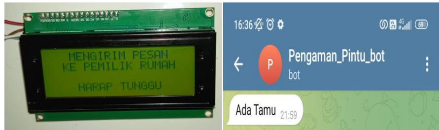
Gambar 4. Hasil Pengujian Push Button luar, LCD dan Telegram
